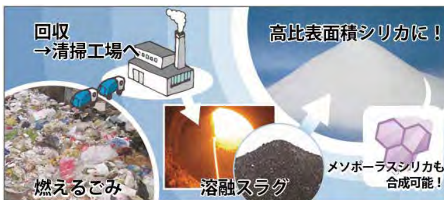
図9 燃えるごみの焼却残さである溶融スラグを高付加価値材料に変換
