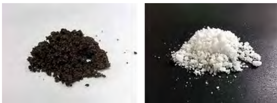
図7 原料の溶融スラグ（左）と合成した高比表面積シリカ（右）
