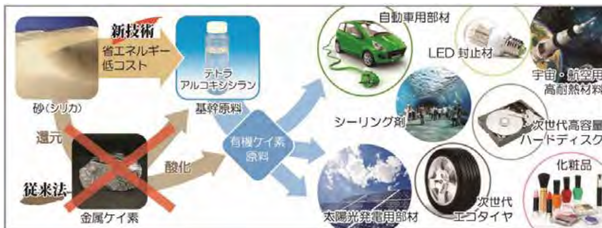
図4 砂(SiO 2 )からの有機ケイ素原料の製造と有機ケイ素材料を含む多様な製品群
