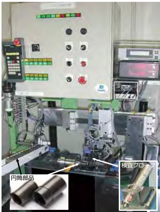
図10 自動車円筒部品の外面傷検査装置
