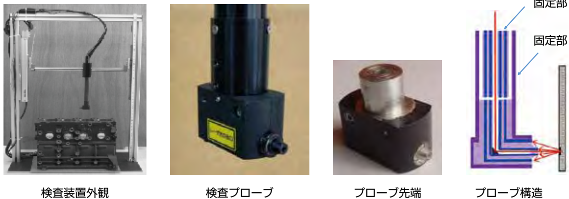
図11 加工穴内壁面検査装置
