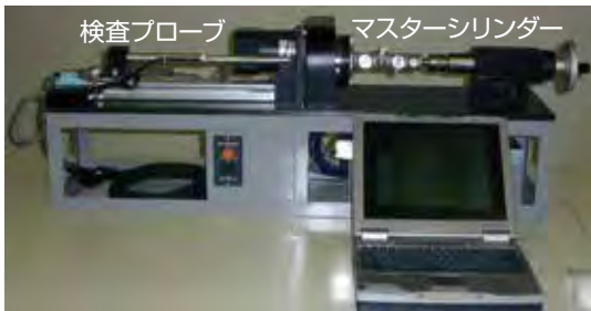
図8 加工穴内壁面検査装置
