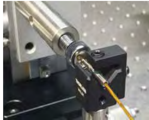
図8 直径1.5 mmの回転プローブ外観図(左)と試料(M6ネジのヘッド部分)測定の様子(右)
