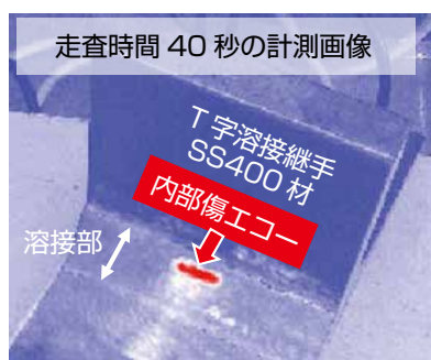
①走査速度：1,000 Hz、走査ピッチ 0.8 mm
