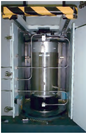
図 8 材料試験機の試験片を取り付ける部分に設置する压力容器
