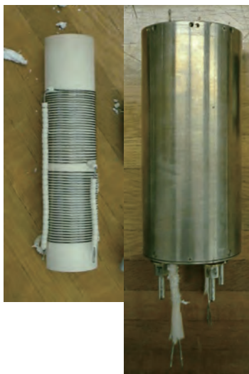
図 9 独自開発したヒーター（電気炉）
