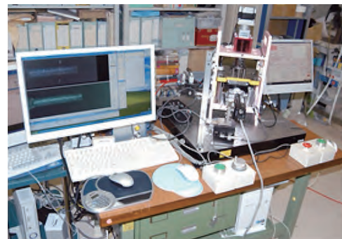
図5 パンチの寿命評価装置 カメラ2台用いて、毎ショット後にパンチの表面を観察できるようにしてある。
