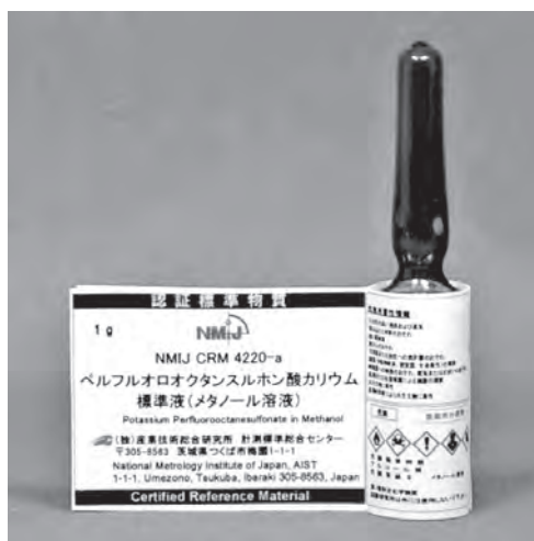
図10 ペルフルオロオクタンスルホン酸カリウム標準液(NMIJ CRM 4220-a)
