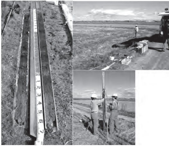
図3 仙台平野における津波堆積物調査 収穫の終わった水田で、ジオスライサーを用いて地下の地層を抜き取る。
