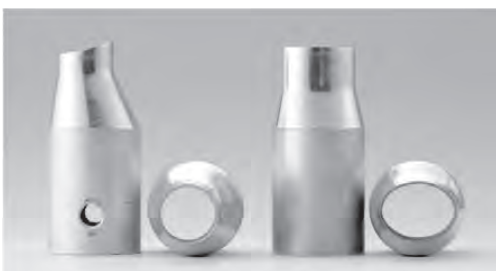
図6 2ローラー加工機を用いた同期スピニング
