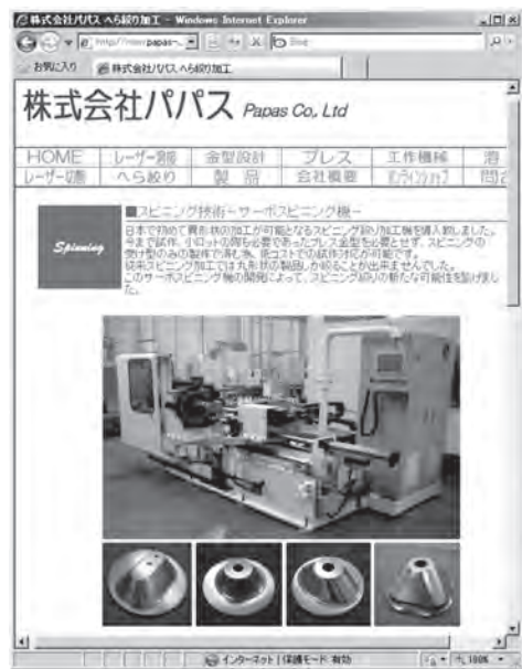
図8 企業に導入された異形スピニング加工機
