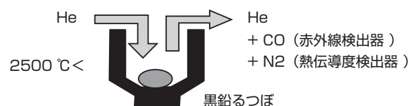
図 2 不活性ガス融解法の概念図
