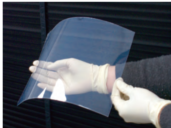
図4 Asahi-Uの凹凸形状を転写したPENフィルムの外観写真
