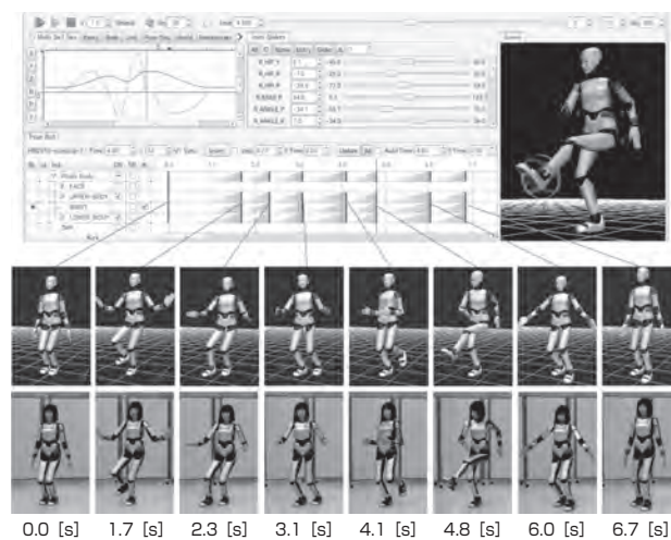
図5 全身動作振り付けシステムの動作編集画面と作成した動作（キーポーズ）の例
