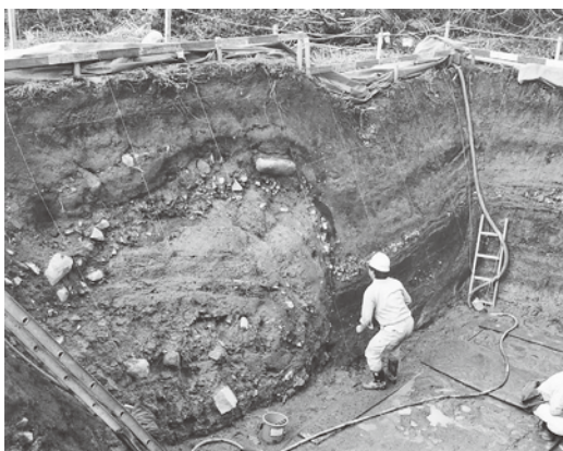
図1 活断層のトレンチ調査の例（福井県大野市の濃尾断層帯温見断層） この活断層は1891年の濃尾地震で活動したことが知られている。地表の段差が1891年にずれたもの。下の地層（より古い地層）ほど大きく上下に食い違っていることから、断層のずれが繰り返し累積していることが読み取れる。
