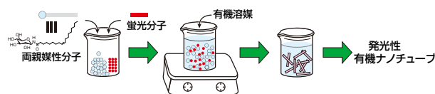
図7 発光性有機ナノチューブの製造工程
