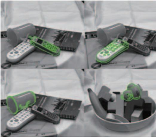
作業の対象となる物の CAD データをロボットに与え、3D データから物の位置や姿勢を検出。3 次元視覚システム VVV は、ロボットの知能化を支える技術の一つ。
