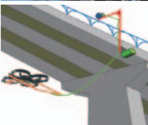
有線給電式で飛行するマルチコプターを使い、高精細な画像で橋梁を点検するシステムを、川田テクノロジーズ(株)などと共同開発。
