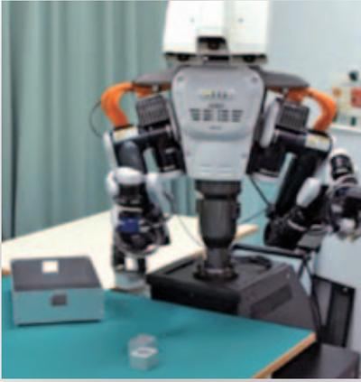
ステレオビジョンを搭載した双腕ロボットによる部品整列作業。与えられた情報から動作を計画し、器用に動く。
