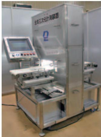
農水産物をベルトコンベヤーで運びながら計測できる全周 3 次元形状計測システム。右は魚フィレの測定例と、切り身への加工例。
