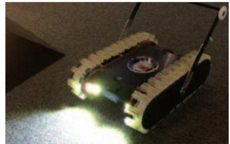
小型移動検査ロボット「DIR-3」は、長さ37cm×幅29cm×高さ12cm、重さ7kg。多数のセンサーやカメラ、通信アンテナ、照明などを搭載。
