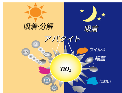
アパタイト被覆光触媒による殺菌・環境浄化
