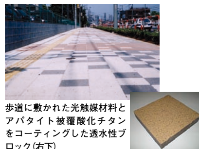
酸化チタンをコーティングした多機能複合材料
