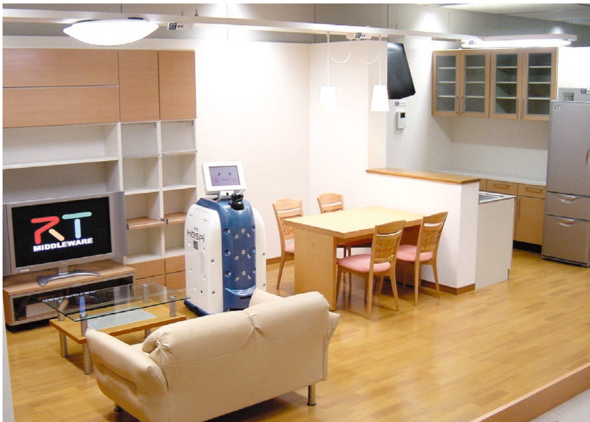
生活支援ロボットシステム (住居空間に分散配置された機能部品が、連携動作することで住人に様々なサービスを提供するインテリジェントな居住空間)
