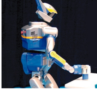
ロボットの目で缶を確認してからつかみます
