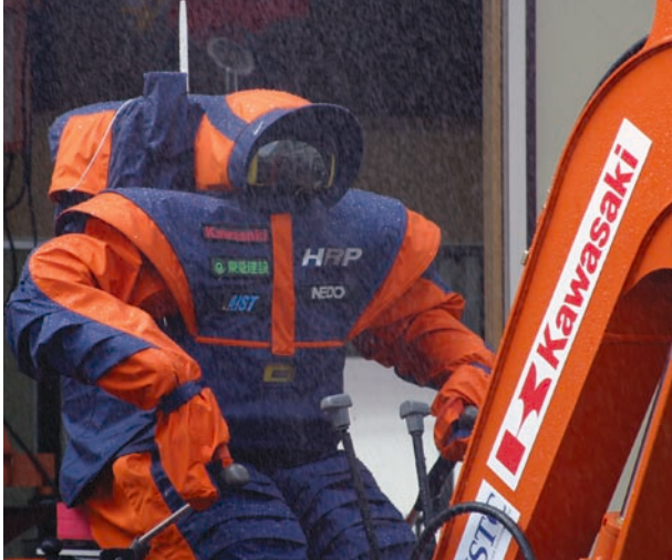
防水用の防護服を着てバックホーを運転
