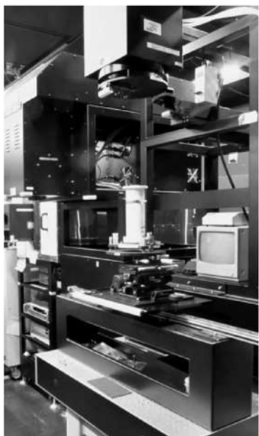
製品化された高平行度ソーラーシミュレーター(日米で特許取得)
