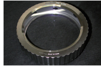
Φ100mm 90% λ/100 平面原器 (ハウジングへポッティング後)
