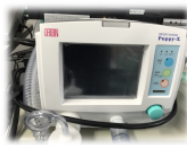
図2. ガイドラインに準拠した情報出力を持つ人工呼吸器 (Puppy-X, オリジン医科工業製)
