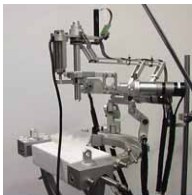
図 20: 緊急退避機構を正しい姿勢に戻した手術部の様子
