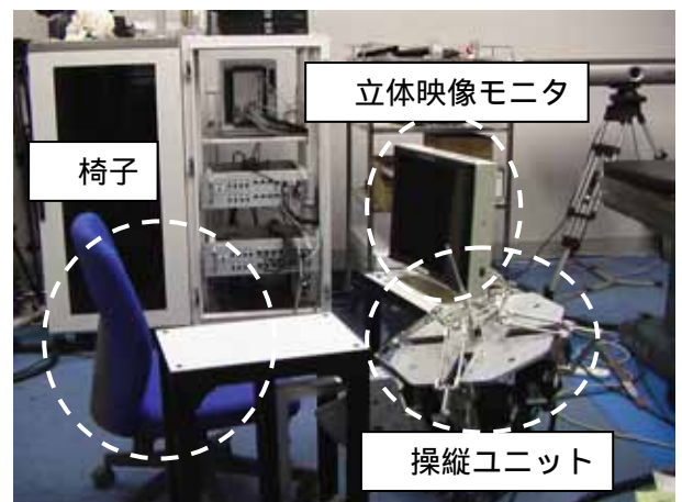
図6：操縦部全体の写真
