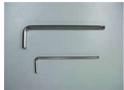
図 19：手術部の設置に用いる工具(六角レンチ)
