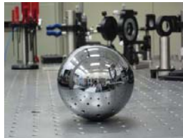
1 kgの ^{28}\text{Si} 濃縮結晶球体
