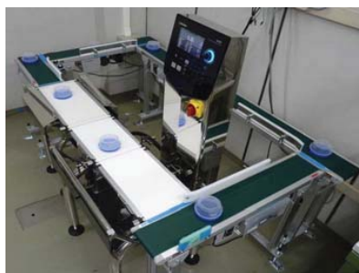
型式承認試験評価手法の研究開発 周回コンベヤによる無人連続計量実験
