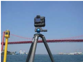
長大橋のたわみ計測
