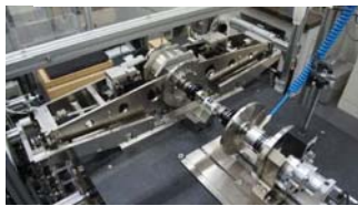
実荷重式トルク標準機
