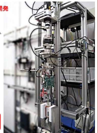
電磁式トルク標準機
