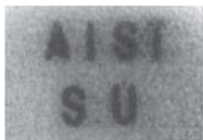
鉄5cm厚 0.1秒1ショット のX線による透過イメージ
