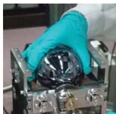
28 Si同位体濃縮球体のための回転試料台の開発
