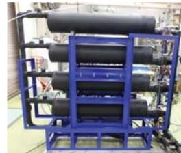
新規開発合金を用いた水素貯蔵装置
