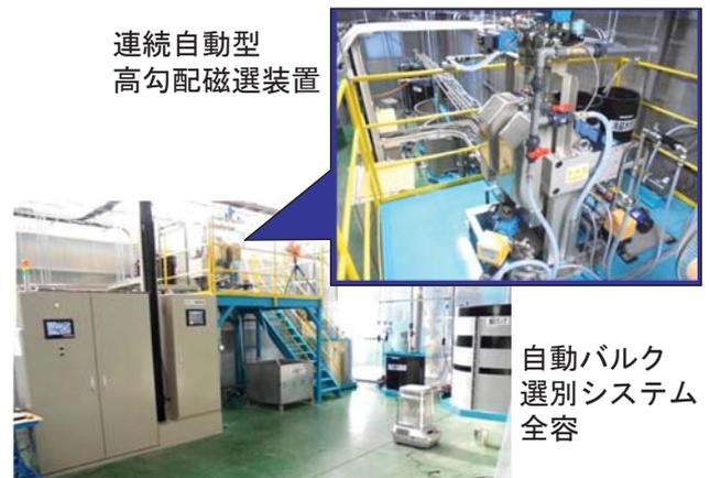
図2 実用化した自動バルク選別システム
