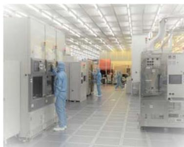
スーパークリーンルーム内に新たに構築した**大口徑(6インチ対応)SiCデバイス試作ライン**
