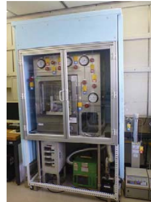
超臨界CO 2 シール圧測定装置
