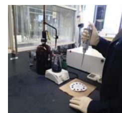
ベントナイトのメチレンブルー吸着量試験の様子
