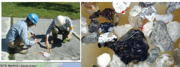
光学・電子顕微鏡による噴出物の解析と噴火メカニズムの把握
