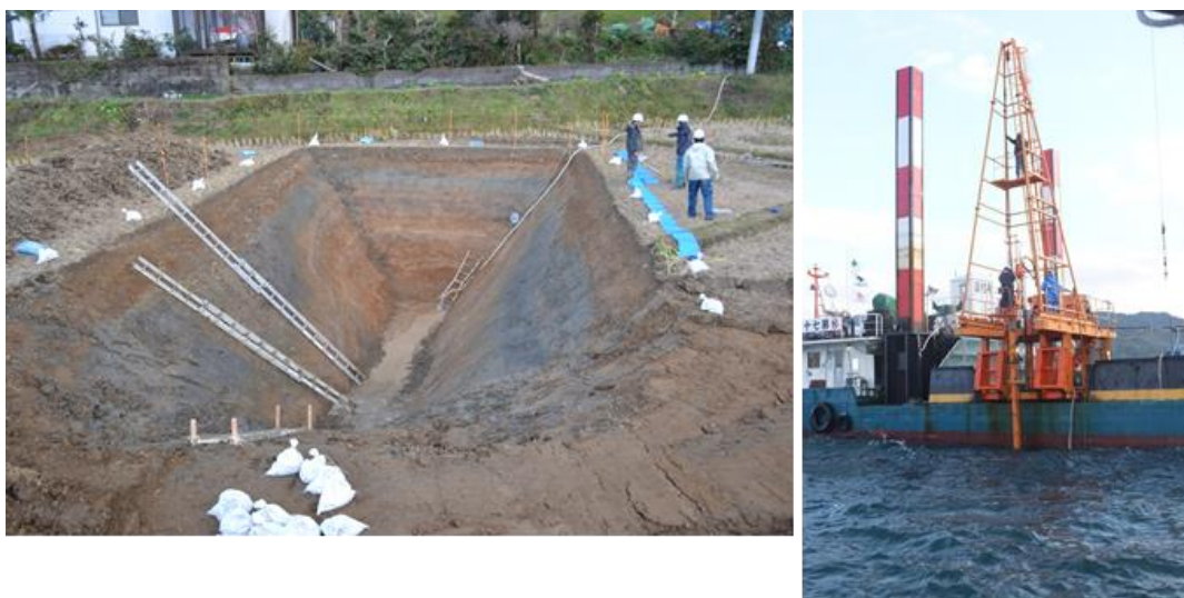
図 4 平成 28 年熊本地震を踏まえた総合的な活断層調査 左：日奈久断層帯 高野・白旗区間の活動履歴解明を目的としたトレンチ調査の様子。熊本県上益城郡甲佐町白旗山出にて掘削（平成 29 年 1 月）。右：日奈久断層帯延長部の海域におけるボーリング調査の様子。
