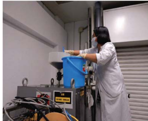
青サバ水簸物の湿式高磁力磁選による脱鉄実験
