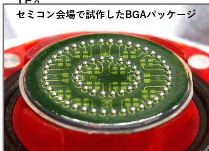
BGAパッケージを搭載するプリント基板例
