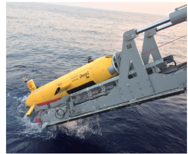
図1 AUV（自律型海中探査機）の投入。3種の音響機器で探査を実施。
