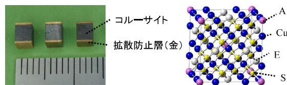
図2 (左)資源制約の少ない元素(銅と硫黄)を用いた熱電変換材料(コーナースイト Cu_{26}A_2E_6S_{32} (A = Nb, Ta; E = Ge, Sn))。 (右)複雑な結晶構造に起因した低い格子熱伝導率が高い熱電性能指数をもたらす。
