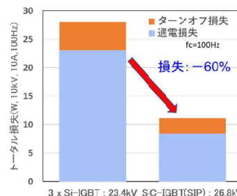
図1 20kV級SiC-IGBTとSi-IGBT3直列の損失比較
