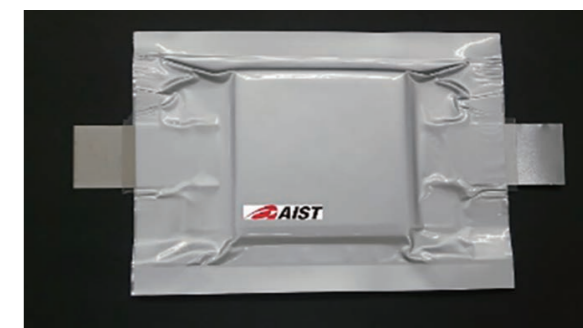
試作した蓄電池 (8 Ah)
