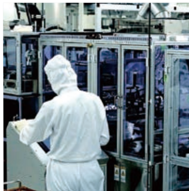
有機薄膜トランジスタアレイ印刷製造ライン
