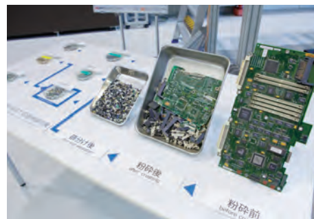
自動選別システムによって金属の種類ごとに選別されるパソコン用プリント基板の例
