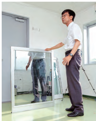
建物に実装できる調光ミラーガラスで省エネ性能を測定
