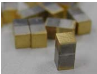
Zn_4Sb_3/Bi_2Te_3 セグメント型熱発電素子
