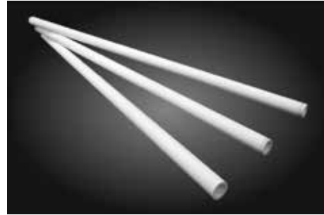
【写真2】高い二酸化炭素選択性を持つゼオライト膜を開発
