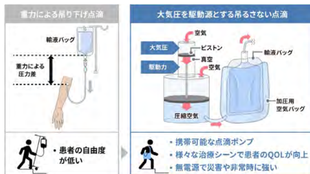
大気圧を駆動源とする吊るさない点滴の概念図
