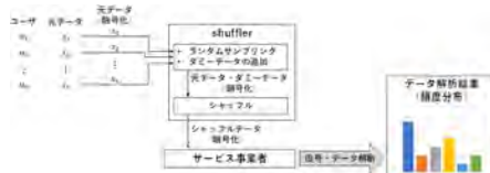
図2: 開発したプライバシー保護データ解析プロトコル「local-noise-free protocol」
