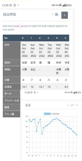
日本酒のまろみ製造工程を模擬したテストベッド 品温などを記録・データベース化(徳島県)
