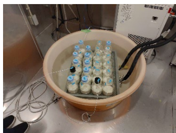
日本酒のまろみ製造工程を模擬したテストベッド 品温などを記録・データベース化(徳島県)
