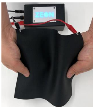
柔軟な導電性CNTシリコンゴムシート (写真：日本ゼオン提供)
