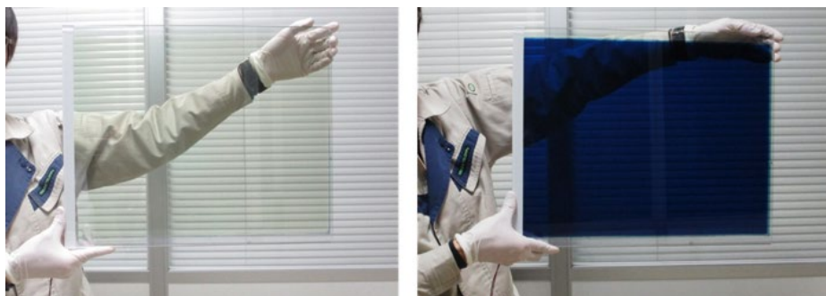
今回作製した透明時(左)と遮光時(右)のG2サイズ調光デバイス
