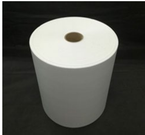
図1 今回作製した高性能複合断熱材のロール(幅400mm×長さ30m×厚さ2mm)
