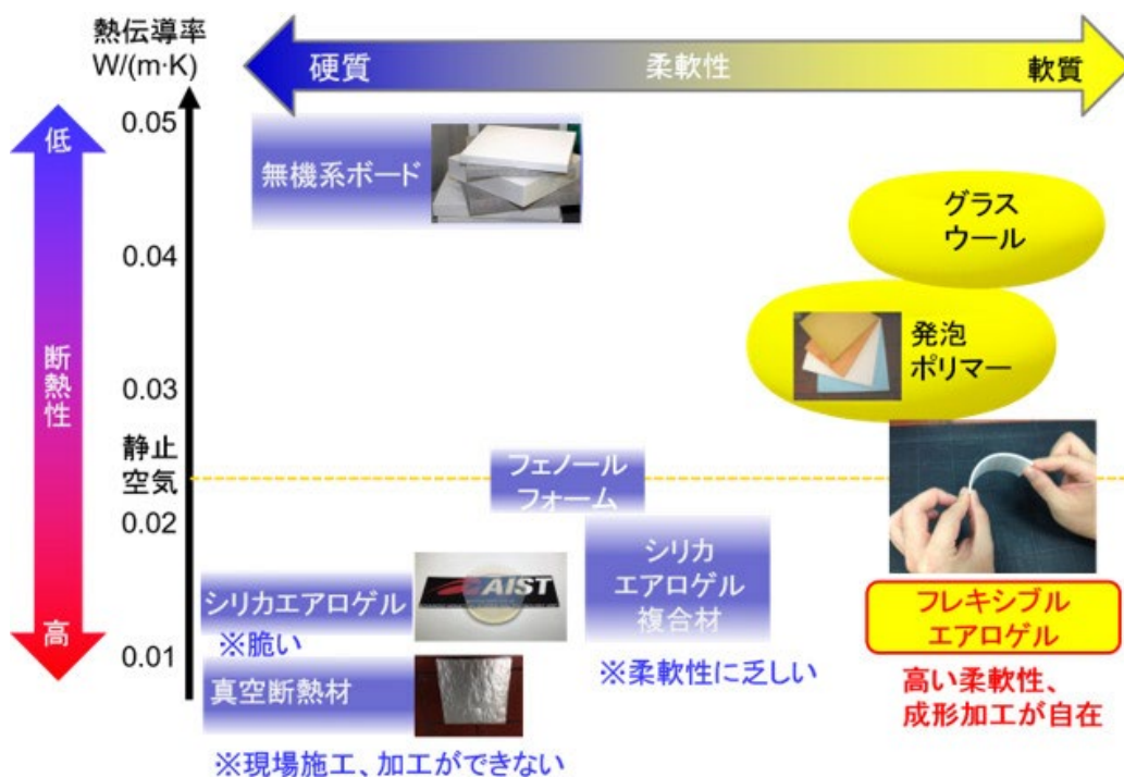
図2 高性能断熱材の熱伝導率と柔軟性
