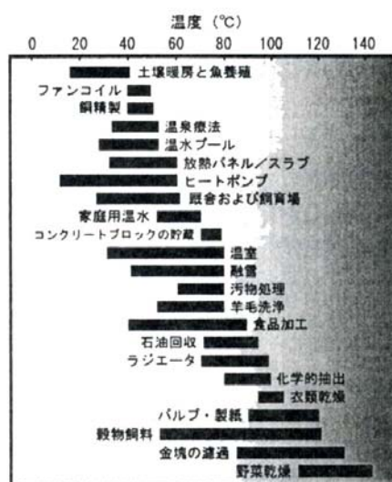
図 5-3 地熱流体の温度別利用方法
