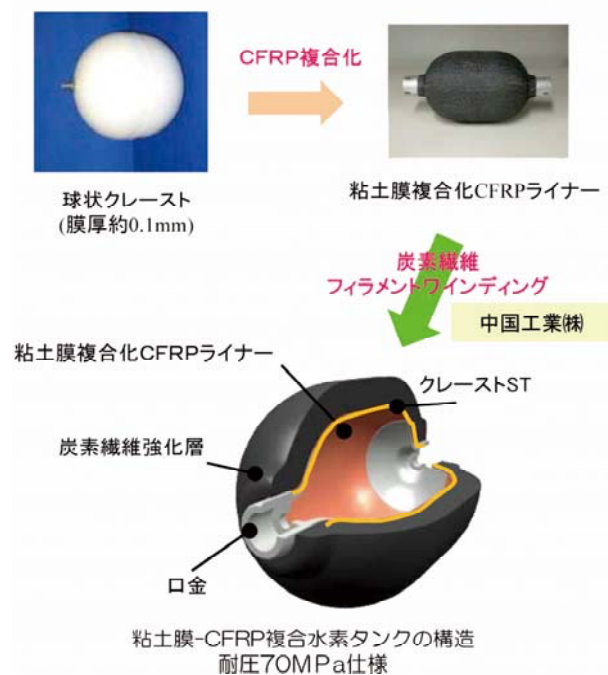
図 5-6 粘土膜 - CFRP 水素タンクの製造プロセス
