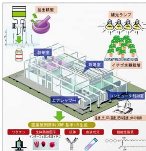
図 4-27 遺伝子組換え植物を使った医薬品原料生産のための密閉型遺伝子組換え植物工場システム [4-45]
