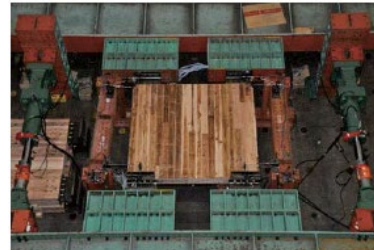
CLT耐震壁の実大試験状況
