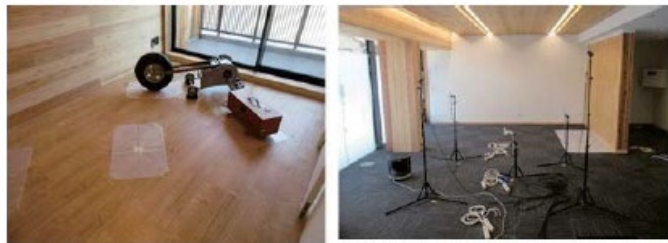
重量床衝撃音打撃状況(2F; 住戸)
