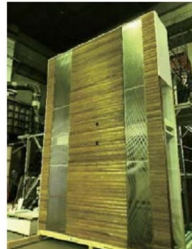
木質外装実大試験体
