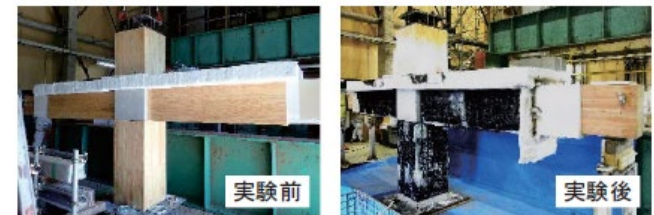
木柱・梁・PCa接合部載荷加熱実験
