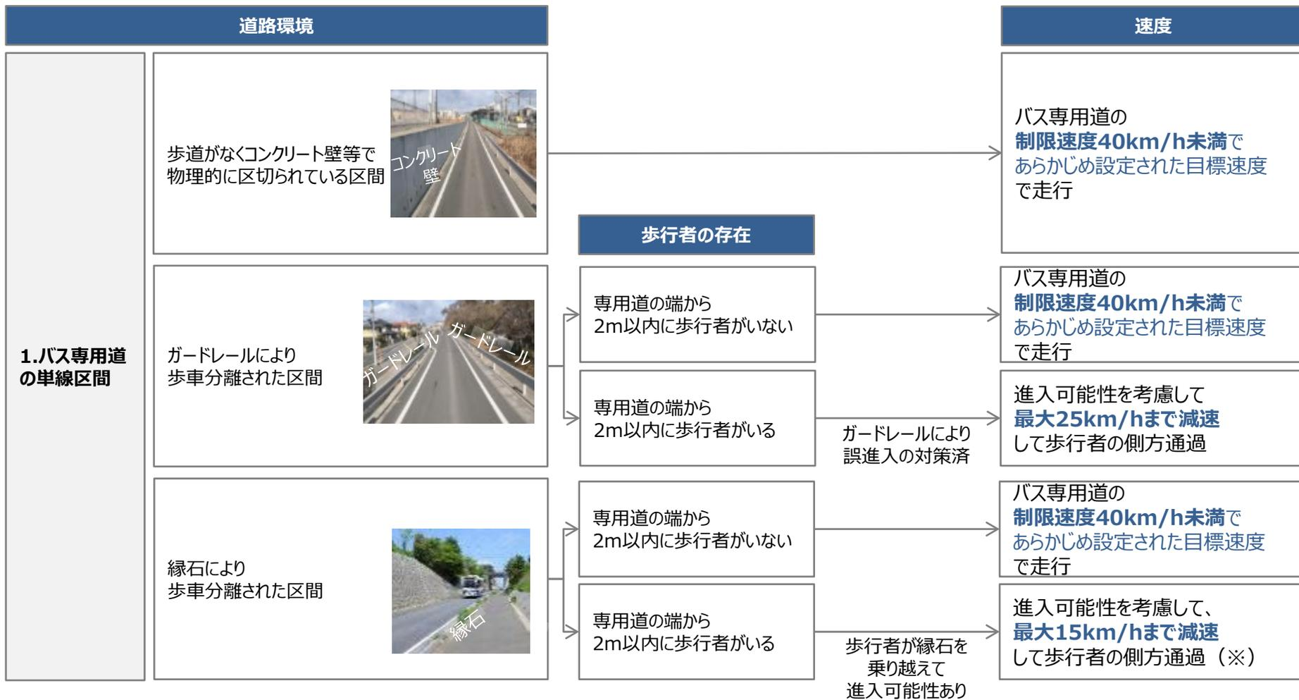
(※) 歩行者が停止した状態から1.5m/s<sup>2</sup>の加速度で進入してきた場合、1.9秒で走行軌道に到達。自動運転バスは15km/hで走行し、飛び出しを検知したら、2.5m/s<sup>2</sup>で減速すれば衝突回避できる。
