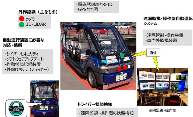
遠隔型レベル3の自動運行装置：**ZEN drive Pilot**
