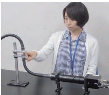
図1 開発した無侵襲血液検査の試作装置
