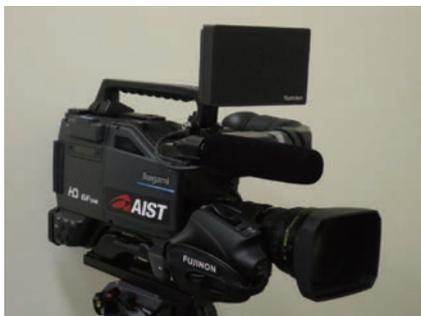
図1 開発した赤外線ハイビジョンカラー暗視カメラ
