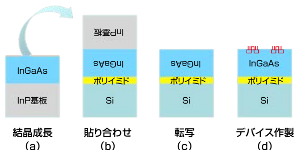
図2 ポリマー上のトランジスタ作製方法
