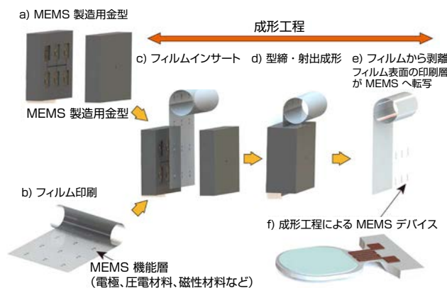
図1 印刷工程と射出成形によるMEMS製造工程
