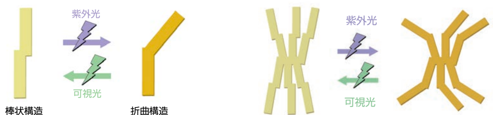
図2 アゾベンゼンの光による構造変化(左)と今回用いた化合物の光による構造変化(右)
