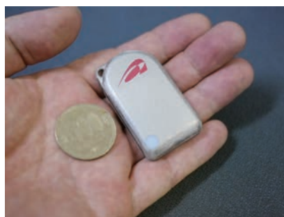
図1 開発した小型放射線積算線量計（右）と比較のための500円硬貨（左）
