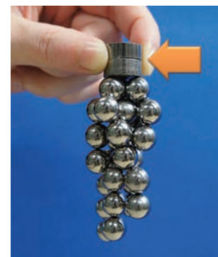
図2 今回開発した重希土類元素を含まない高性能焼結磁石 (Sm-Fe-N系) 高性能焼結磁石を2段重ねにしたものに、鉄球30個が磁着している
